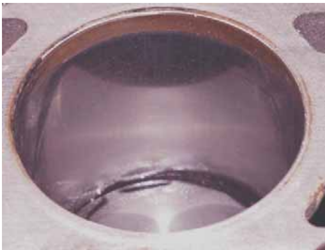
Abb.5-1: Digitalaufnahme des Motorblock Ford Escort,nach der Behandlung (Veränderung der Oberfläche ist durch Betrachtung bereits erkennbar)
