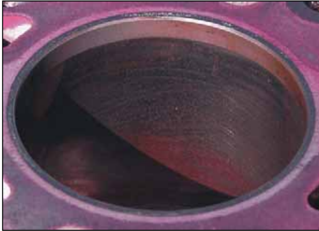
Abb.4-3: Digitalaufnahme des Motorblock Ford Escort, vor der Behandlung (Erkennbar sind Hohnriefen der Zylinderflächen)
