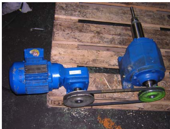
Versuchsaufbau: Motor 3 mit Belastungsspindel
