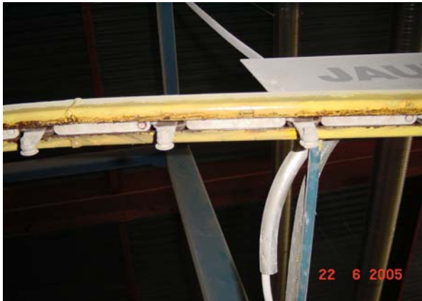
Kuvat 13. ja 14. 120 metrin jauhemaalauslinjan rakenne ja korkean käyttöasteen rasitukset ovat silmin nähtävissä.
