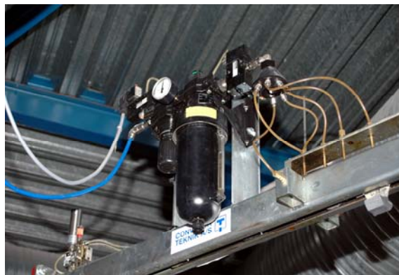
Kuva 6. Rullien laakerit saavat kukin erikseen voitelunsa keskusvoiteluyksikön kuuden suuttimen kautta.
