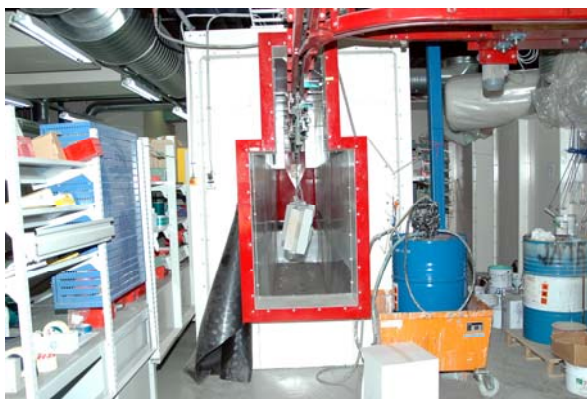
Kuvat 7. ja 8. Jauhelinjoissa kuivatusuunien korkea lämpötila (n. 220 °C) ja pöly ja märkälinjoissa liuottimet kuivattavat ja likaavat kiskoja ja rullia ja aiheuttavat meluhaittojen lisäksi tahmeutta, nykimistä, maalattujen kappaleiden roskaantumista ja pahimmillaan linjan ”jumiutumisen”.
