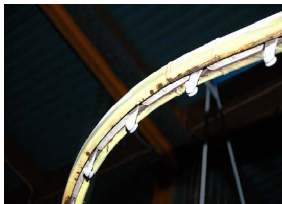
Kuvat 7. ja 8. Jauhelinjoissa kuivatusuunien korkea lämpötila (n. 220 °C) ja pöly ja märkälinjoissa liuottimet kuivattavat ja likaavat kiskoja ja rullia ja aiheuttavat meluhaittojen lisäksi tahmeutta, nykimistä, maalattujen kappaleiden roskaantumista ja pahimmillaan linjan ”jumiutumisen”.
