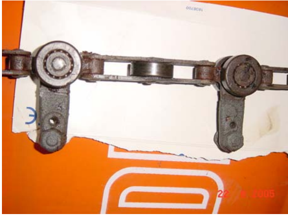
Kuvat 11. ja 12. 60 metrin linjoissa oleva rullayksikkö on n. 15 cm pitkä ja rullan halkaisija on noin 40 mm. Rulla-laakerin halkaisija on n. 20 mm. Rulliin keräytyvä lika erottuu kuvissa selvästi.
