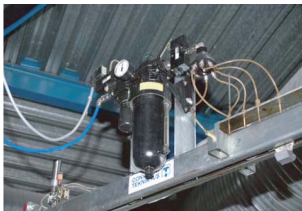
Foto 6 Vart och ett av lagren i rullarna smörjs separat genom sex munstycken i centralsmörjningsenheten.
